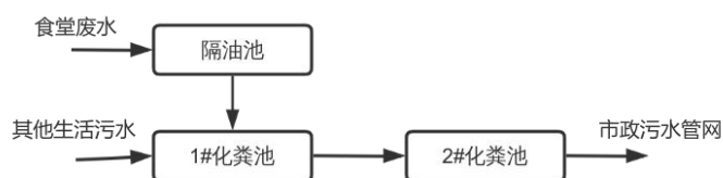
图 4.2-2 生活污水处理工艺流程图
