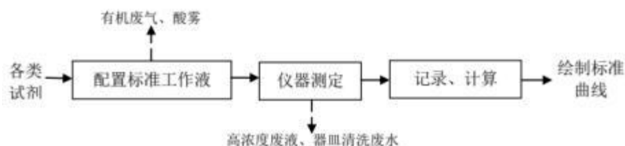
图 2.10-4 标准工作液配制流程图
