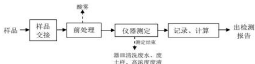
图 2.10-5 样品检测实验流程图
